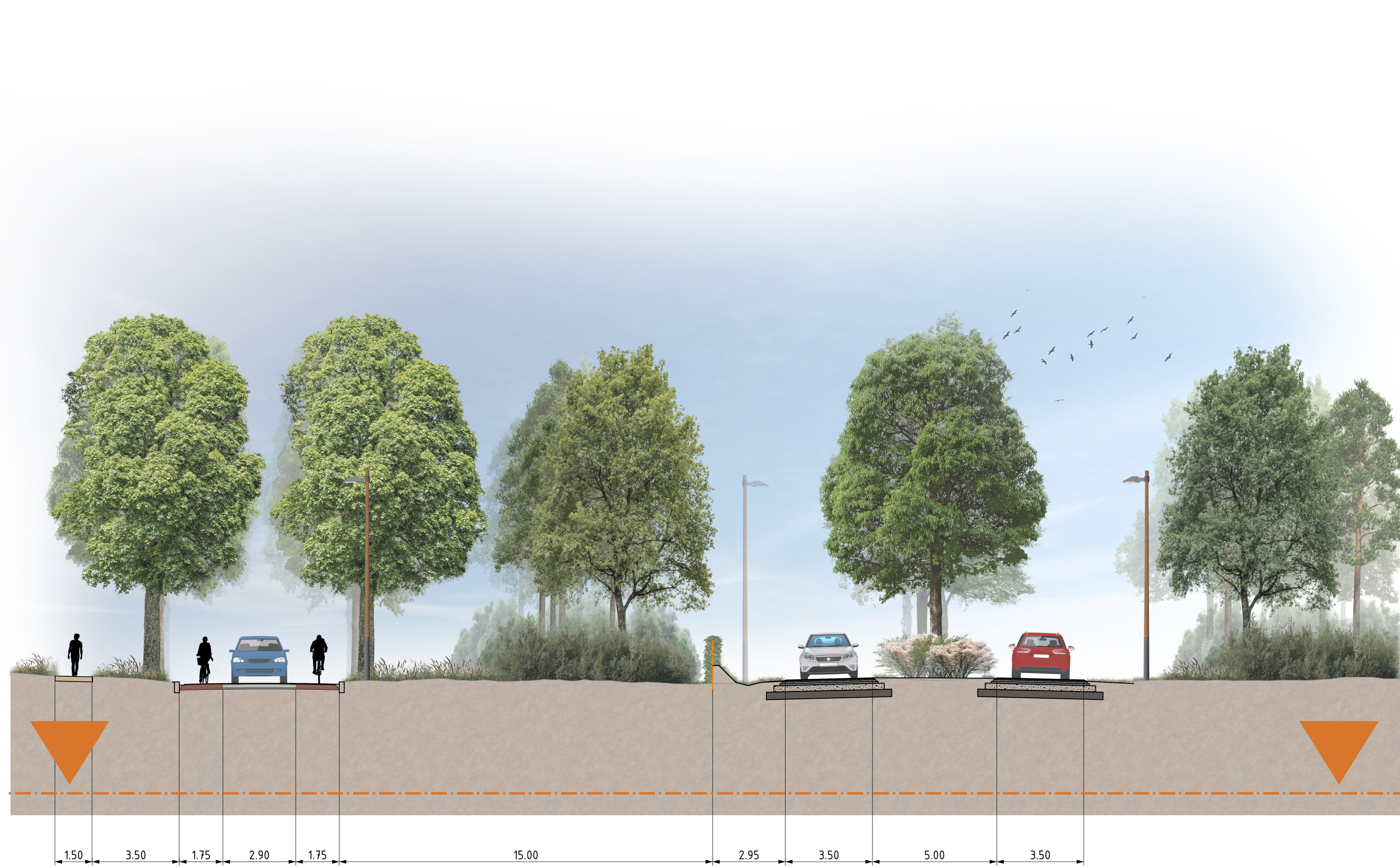
Dwarsprofiel van de Nieuwe Kazernelaan en Parklaan tussen de rotonde N224 en kruispunt Buurtmeesterweg - Simon Stevin
